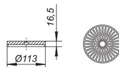
Nur in Verbindung mit Flanschring S 10 einsetzbar (Art.-Nr. 839503).
